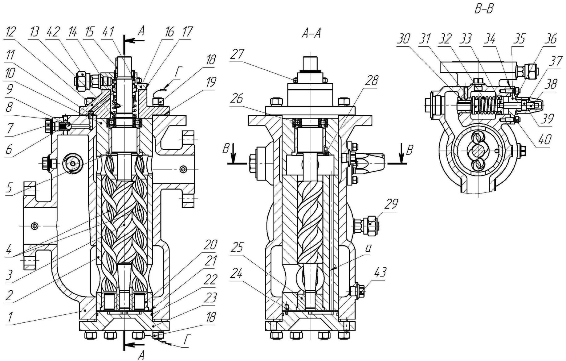
Рисунок 1 – Устройство насоса
